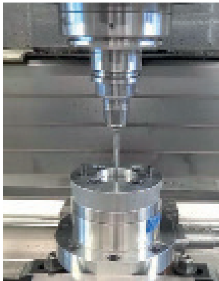
Einsatzbeispiel: Vibrationsunterstütztes Bohren mit PKD in Titan
