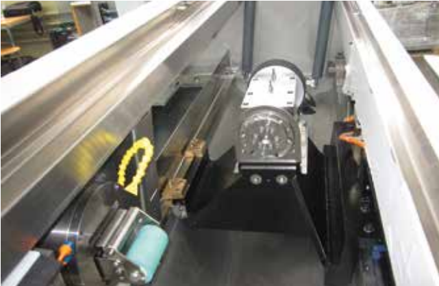
4 Spindeleinheit in der Cylinder-Finishing-Maschine
