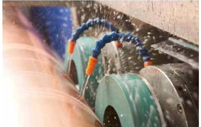
5 Schleifprozess der Mantelfläche eines Druckzylinders
