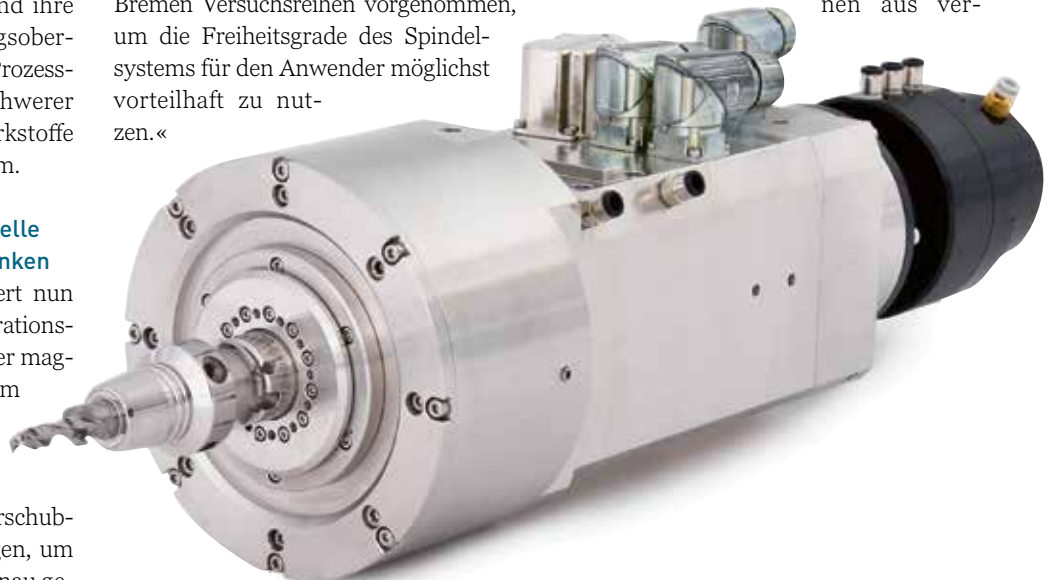
1 Neue Spindeltechnologie mit Magnetlagerung: LTI Motion beseitigt mit dem vibrationsunterstützten Bohren das jahrhundertalte Problem der Wirrspäne; die Lösung brachten die fünfachsig ansteuerbaren Magnetlager, die die Welle schweben lassen (© LTI Motion)
