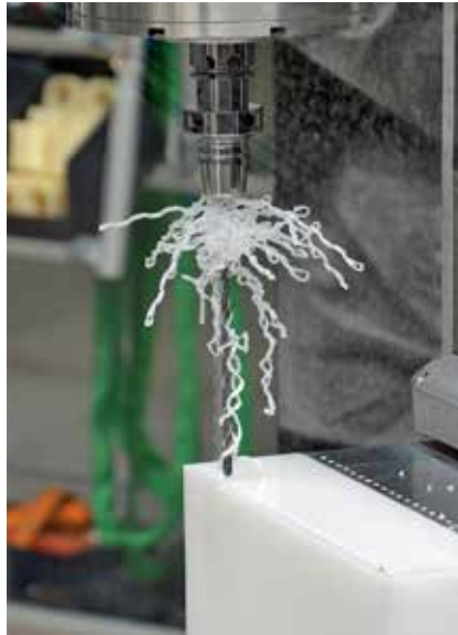
2 Mit und ohne Vibration: Beim Bohren in Polyoxymethylen (POM) entstehen ohne Vibrationsunterstützung die klassischen Wirrspäne (oben); wirkt die neue Technologie, entstehen nur noch gleichförmige Kleinstspäne (unten) (© Hanser)
